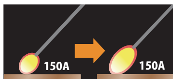
アーク長が長くなり電圧が上昇するが、電流は変化せず。
